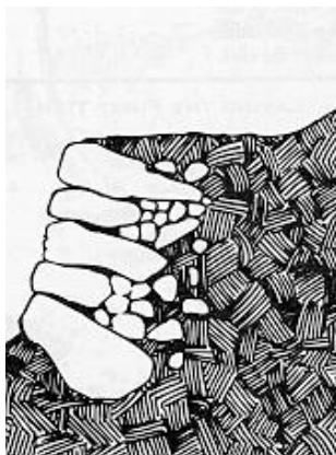
Muros de contenção construídos com pedra ou madeira. Fonte: BIRKBY, 1997.
